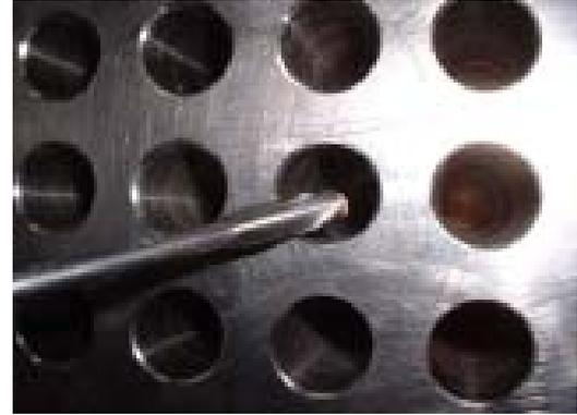
窒素より分子の小さなヘリウムを使うことにより、従来のリークテストでは検出不可能だった微小な漏れを分子レベルで検出する装置です。
